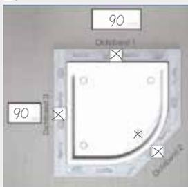
1. Bei diesem Beispiel soll die Ecke links oben und der Abfluss vorne rechts platziert sein. Die Dichtbänder sollen oben und links seitlich platziert werden.
